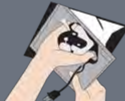
2. Remove old fan assembly
